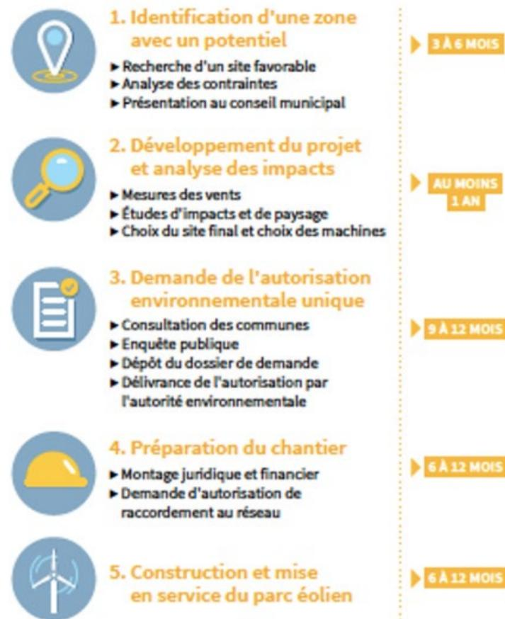
**Des experts réalisent des mesures du vent et des analyses d'impacts.** Des mâts de mesure de la vitesse et de l'orientation du vent sont installés pour connaître précisément le gisement de vent sur une année.
